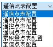
3. 在左上角下拉选择 **遥信点表配置** 进入遥信、遥测、累积量、遥控和遥调的转发点表配置，配置完成要务必
